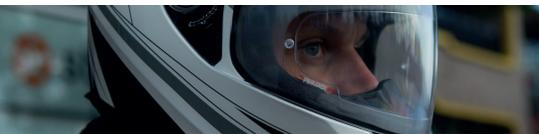
Wie bei einer Doppelverglasung verhilft die entstandene Luftkammer zwischen innerer und äußerer Scheibe zu einem besseren Durchblick bei schlechter Wetterlage. Für die meisten Helme gibt es Nachrüstvisiere.
